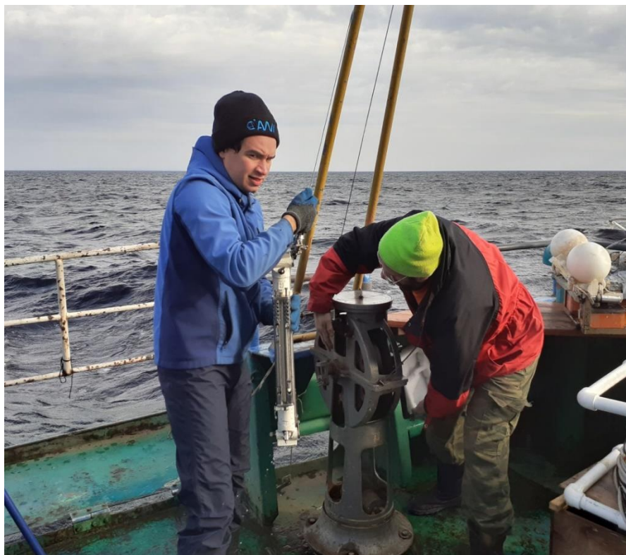
Рисунок 10.18 – Работа с батометром Нансена
