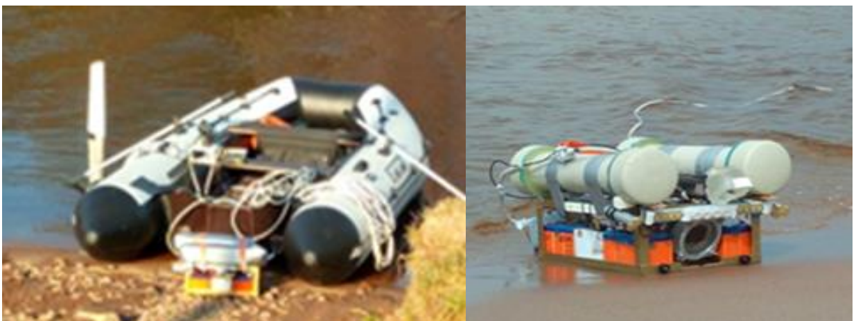
Рис. 10.2 – Средства подводной фотовидеосъемки: слева – надувная лодка с аппаратом «Limnoscout-230» у кормы, справа – аппарат «Limnoscout-230»
