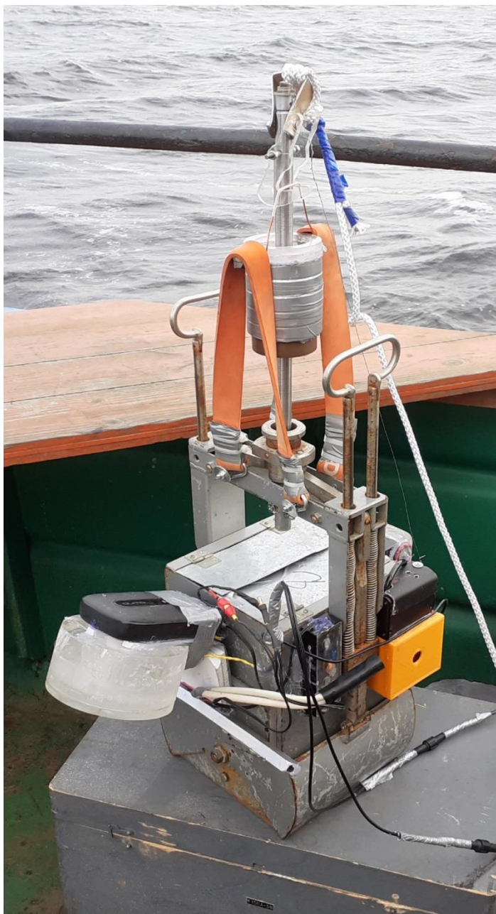
Рисунок 10.16 – Общий вид усовершенствованного дночерпателя Экмана-Берджа
