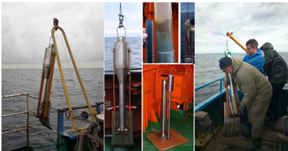
Рисунок 10.11 – Общий вид и работа с трубкой Лаури-Ниёмисте
